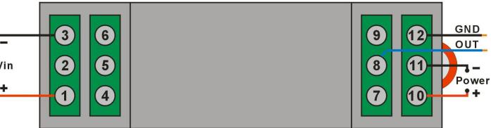
注: 1、3 位端子为输入端子；8、12 位端子为输出端子；10、11 位端子为电源端子；2、4、5、6、7、9 位端子为空脚，无须接线。
