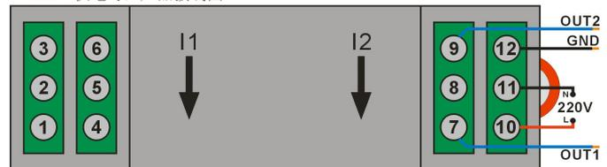
注: 电流穿孔输入; 7、9、12 位端子为输出端子; 10、11 位端子为电源端子。1-6、8 位端子为空脚, 无须接线; 输出地与电源地不共地。
