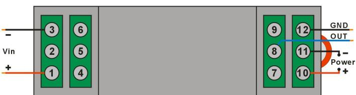
注: 1、3 位端子为输入端子；8、12 位端子为输出端子；10、11 位端子为电源端子。
