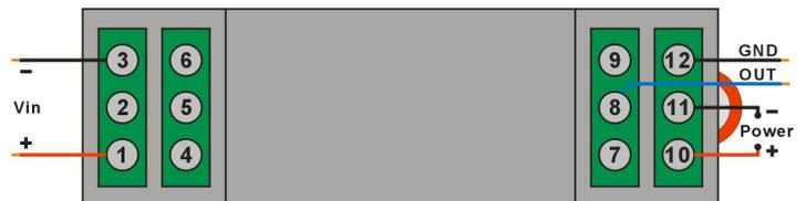
注: 1、3 位端子为输入端子; 8、12 位端子为输出端子; 10、11 位端子为电源端子; 2、4、5、6、7、9 位端子为空脚, 无须接线。
